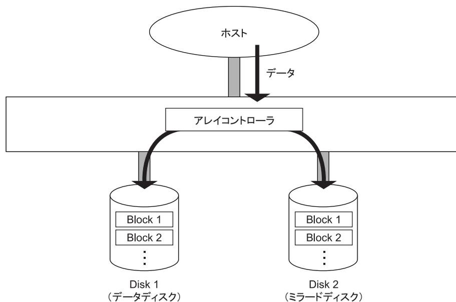
データは、1 台の物理ドライブ（データディスク）と、もう 1 台の物理ドライブ（ミラーディスク）に同じように格納されます。
