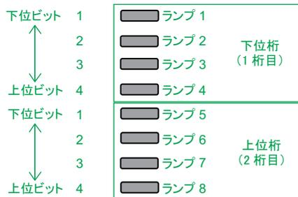
POST (Power On Self Test) が正常に終了すると、ランプ 7、8 のみが点灯します (“CO” を示します)。
